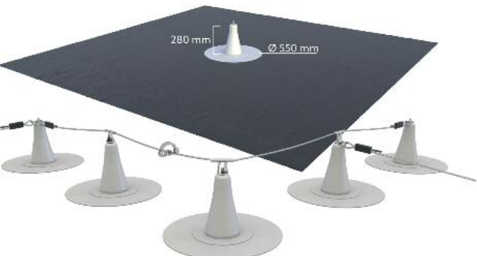
Das auflastgehaltene Absturzsicherungssystem SOPRASAFE ANCHOR PRO-GR (E) besteht aus Geotextil-Haltelieser mit eingearbeiteten Pfosten. In beiden Systemen kommen die gleichen Aufsätze bzw. Kopfteile für die Herstellung von Einzelschlagpunkten oder eines Seilsystems zum Einsatz.
